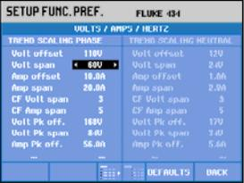
Utilice las teclas de flecha hacia arriba/hacia abajo para seleccionar la escala de tensión. Utilice las teclas de flecha hacia la izquierda/hacia la derecha para aumentar la escala de tensión.
