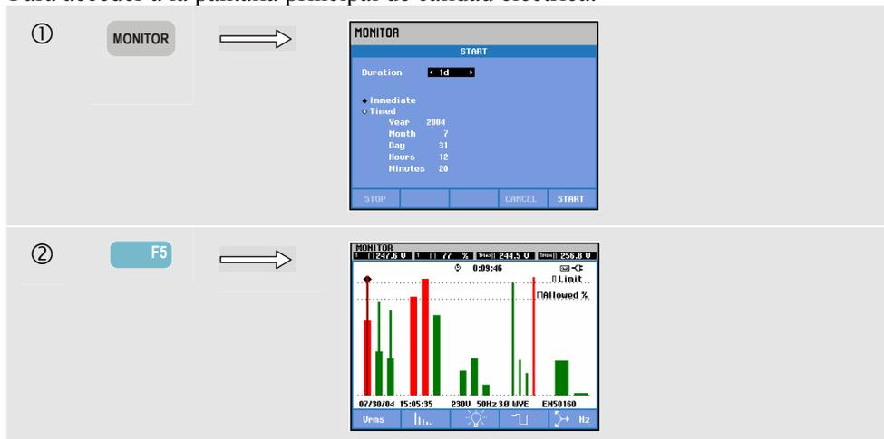
Se puede acceder a la supervisión de la calidad eléctrica por medio de la tecla MONITOR (Supervisión) y un menú para el inicio inmediato o programado. Las teclas de flecha hacia la izquierda/hacia la derecha le permiten colocar el cursor sobre un gráfico de barras determinado. Los datos de la medida pertenecientes a la barra se muestran en el encabezado de la pantalla.
