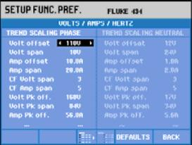
Utilice las teclas de flecha hacia la izquierda/hacia la derecha para disminuir la desviación de tensión.
