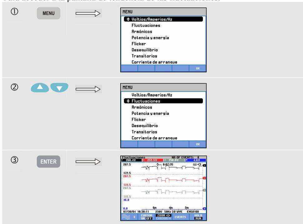
En la pantalla principal, los canales de tensión y corriente configurados se registran de forma que sea posible visualizar la causa y efecto de las desviaciones. No se muestran todos los canales a la vez. Pulse la tecla de función F1 para seleccionar con las teclas de flechas el conjunto de tendencias que se va a visualizar.
