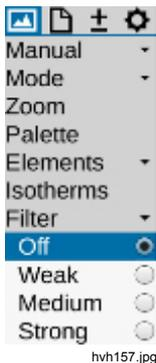
子菜单可以选择四种滤波级：**"Off"**（关闭）、**"Weak"**（弱滤波）、**"Medium"**（中滤波）和**"Strong"**（强滤波）。滤波减少了图像中的噪点，显著改善了低温度梯度场景的图像质量。对于移动的物体或为了记录快速的温度变化，滤波器应该设为**"Off"**（关闭）或**"Weak"**（弱滤波）。
